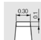
gerade endgripping 0.3 mm x 0.1 mm G-36306 6 mm Griffstück
